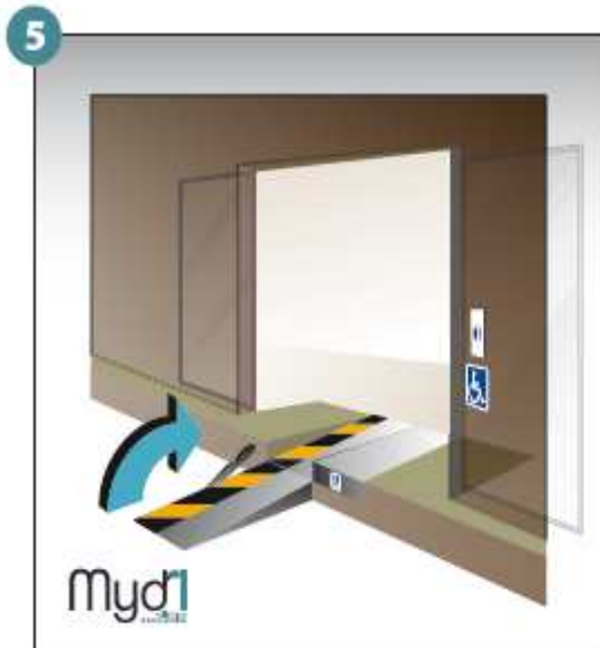
5 - Basculer la poignée qui fera office de chasse roues.
